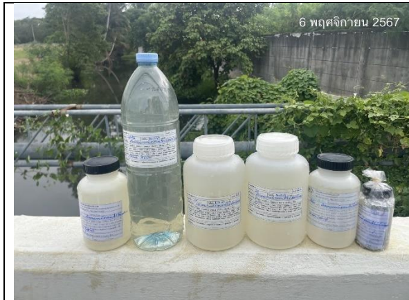
การเก็บตัวอย่างน้ำผิวดินบริเวณจุดที่รับน้ำทิ้งจากโครงการ (จุดระบาย) วันที่ 6 พฤศจิกายน 2567
